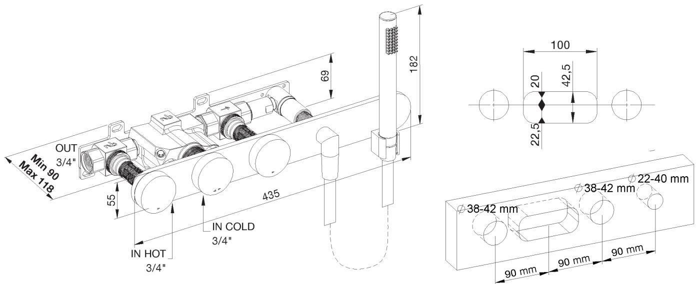
**Encastrement:** La plaque de fixation doit être fixée parallèlement au mur fini
